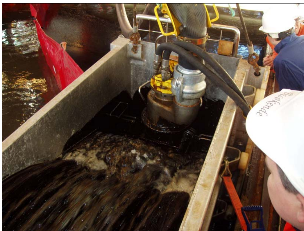
Figur 6 Avskraper og pumpe på Lamor OPC 4
