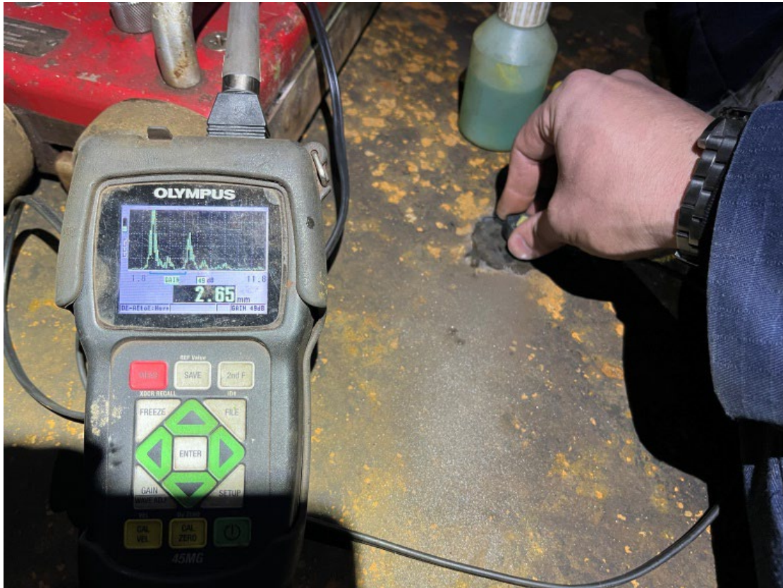
Mynd 11. Þykktarmæling sýnir efnisþykkt gólfs 2.65mm.
