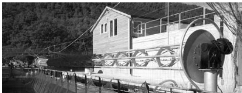
Figur 15. Bilde av et anlegg som bruker automatisk notskiftesystem. På bildet vises en trommel som er plassert ved siden av merden. Notposen synes nede til venstre.
