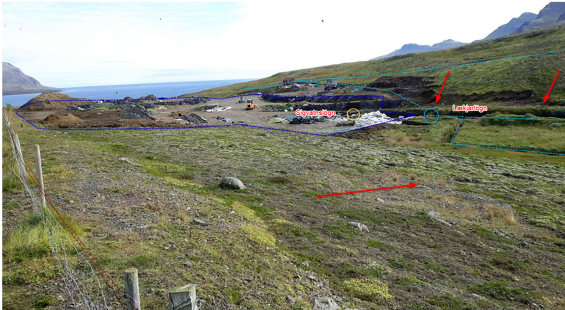
Mynd 5 Mýrdalur horft yfir urðunarstað í átt til sjávar. Halli yfirborðs er táknaður með rauðum pílum. Urðunarstaður sem er opin er merktur með dökkbláum feril. Ljósbláir ferlar tákna drenskurði sem fanga vatn umhverfis urðunarstað.
