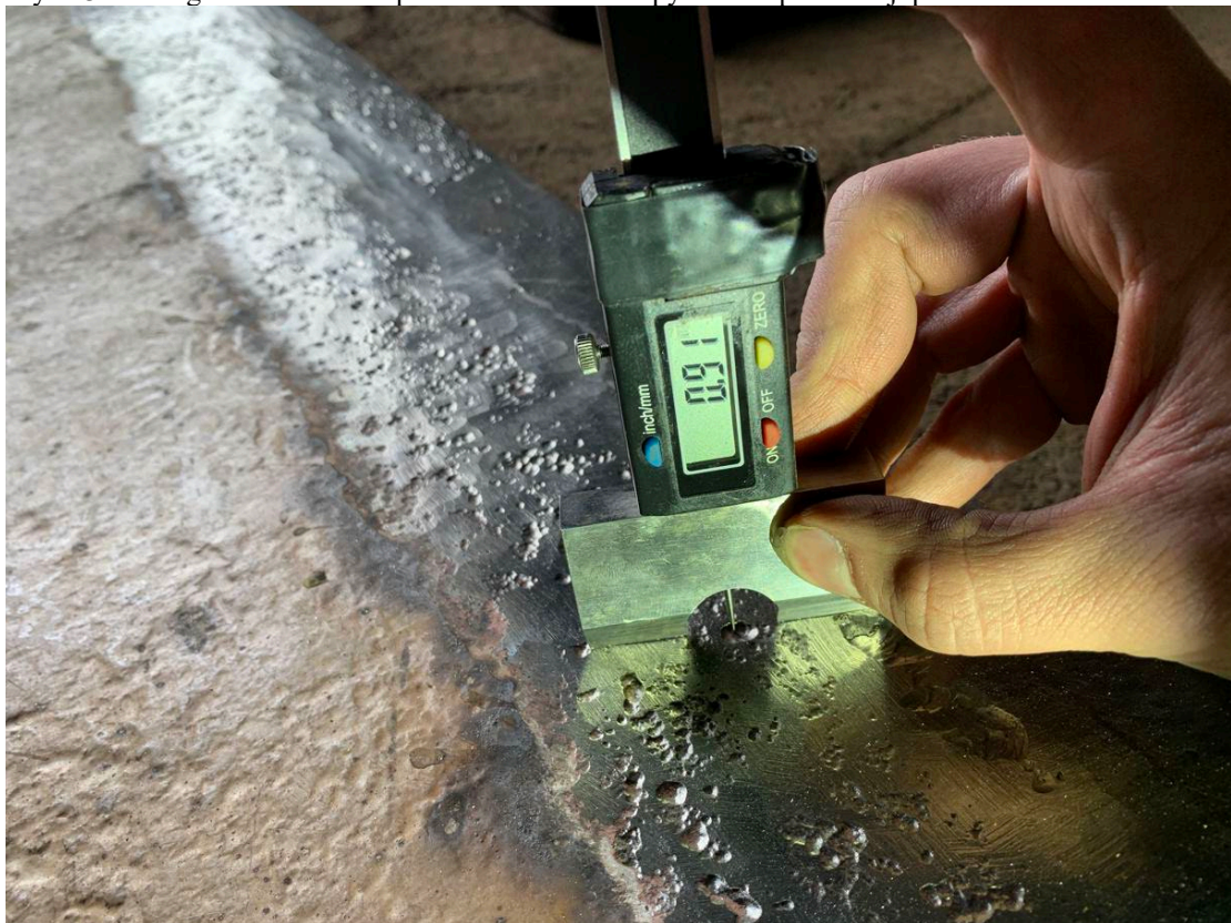
Mynd 4. Dæmigert ástand á botnplötu. Yfirborð alsett pyttum en þó ekki djúpum.
