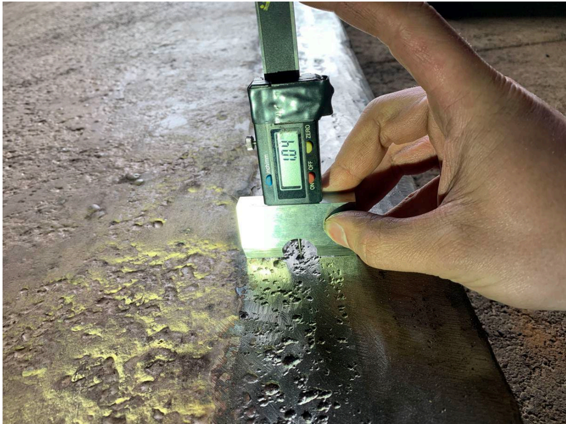
Mynd 3. Dæmigert ástand á botnplötu. Yfirborð alsett pyttum en þó ekki djúpum.
