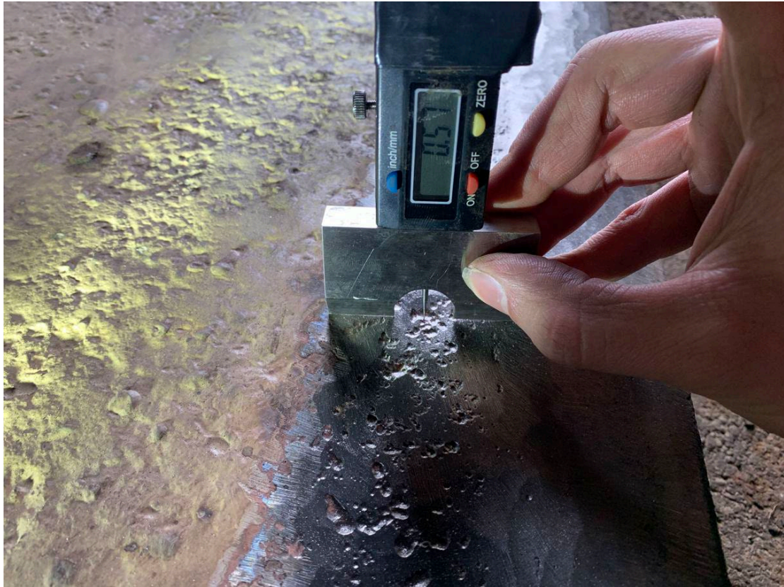
Mynd 5. Dæmigert ástand á botnplötu. Yfirborð alsett pyttum en þó ekki djúpum.
