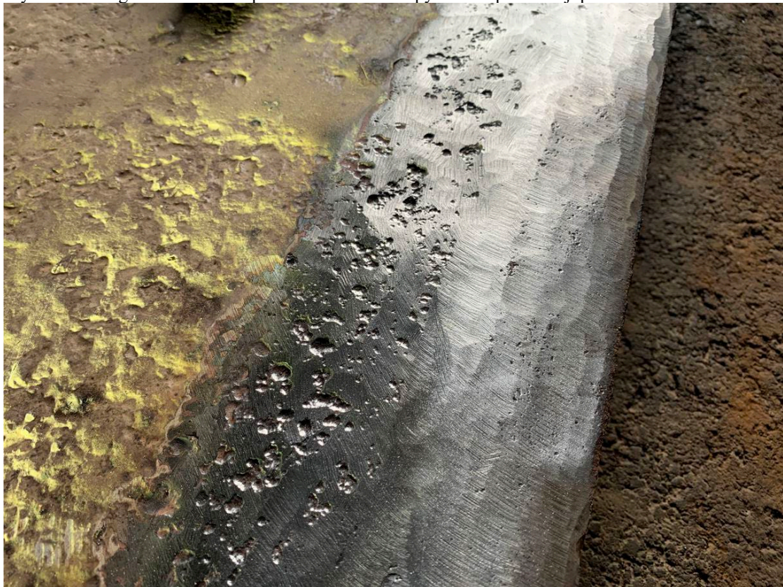
Mynd 6. Dæmigert ástand á botnplötu. Yfirborð alsett pyttum en þó ekki djúpum.
