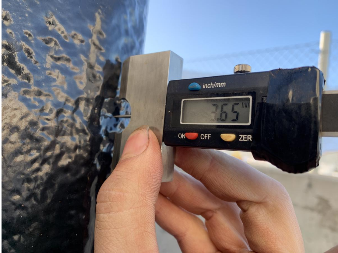
Mynd 4. Hér má sjá tæplega 4mm djúpan pytt á c.a. 7,5-8 mm þykkri plötu.
