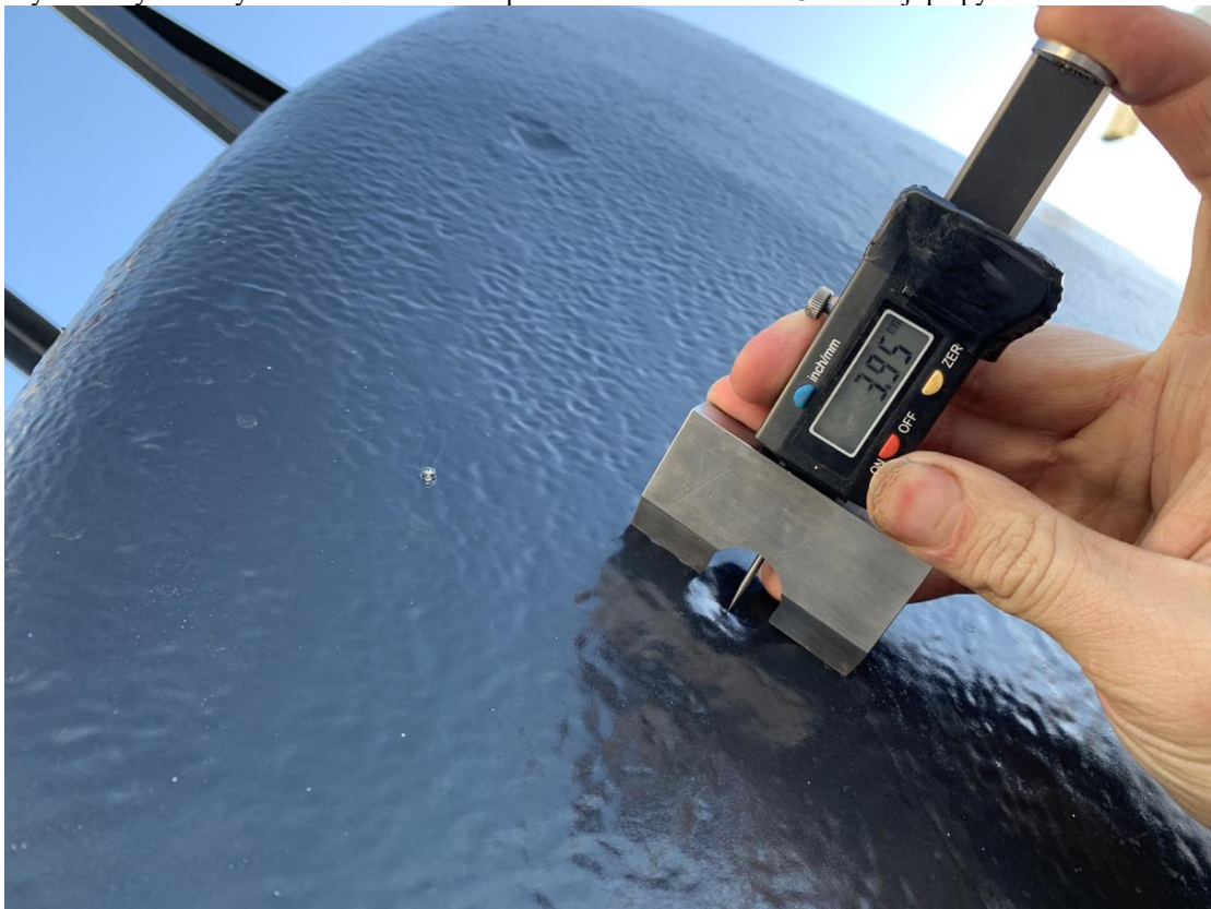
Mynd 3. Hér má sjá tæplega 4mm djúpan pytt á c.a. 9 mm þykkri plötu.
