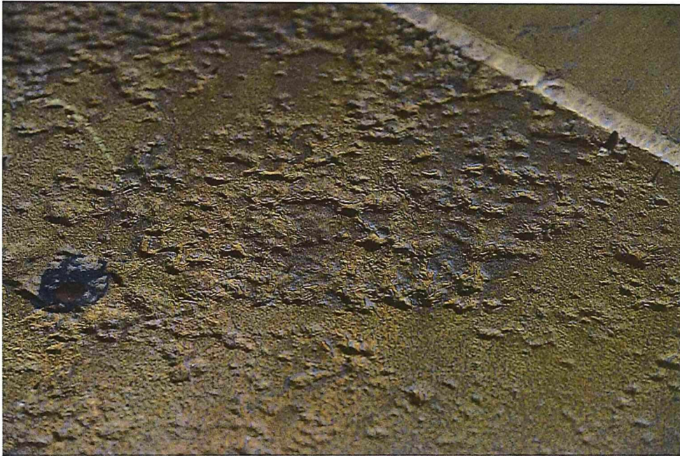
Mynd 7. Víða má finna svæði sem eru tærðari en önnur. Hér eru c.a. 2mm djúpir pyttir í 8mm plötu.
