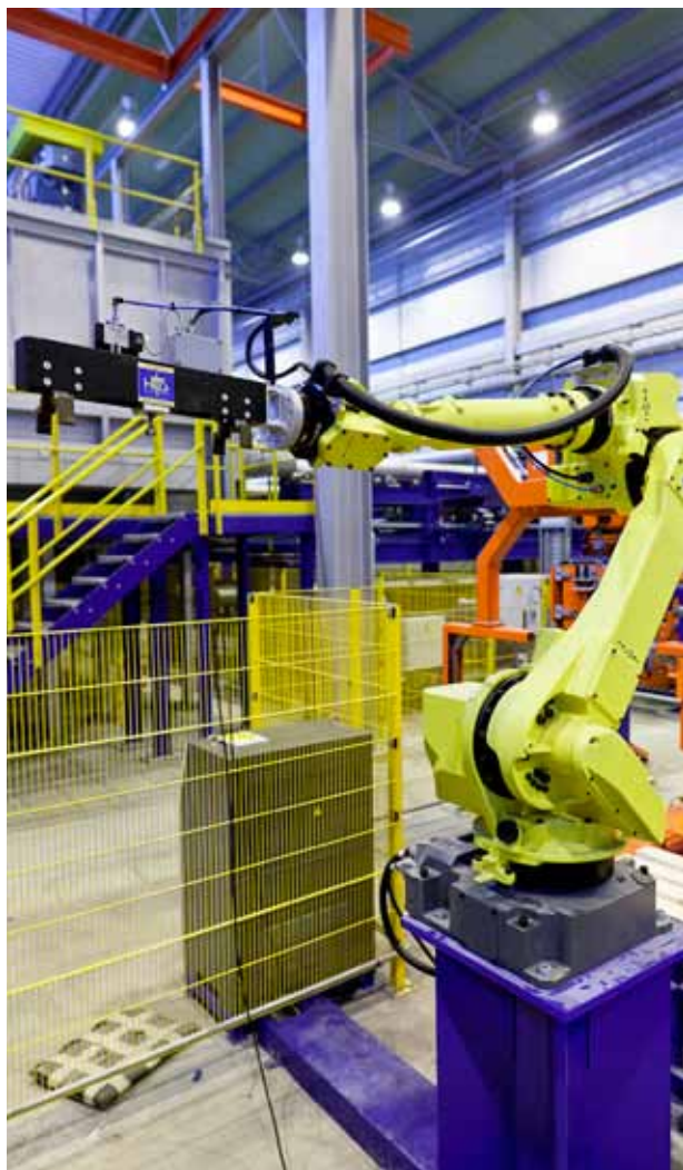
„Timburmaður“ er vélmenni sem meðhöndlar undirleggstímur.
